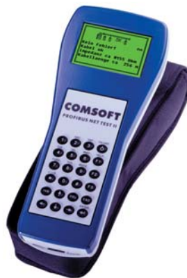
Bild 2: Das NetTest II von Comsoft ermittelt Impedanz/Wellenwiderstand sowie die Kabellänge der angeschlossenen Profibus-Leitung.
